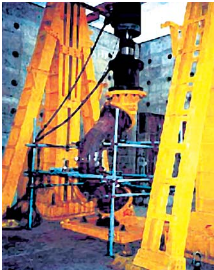
Fig. 2(d) : Actual set up for elbow test
